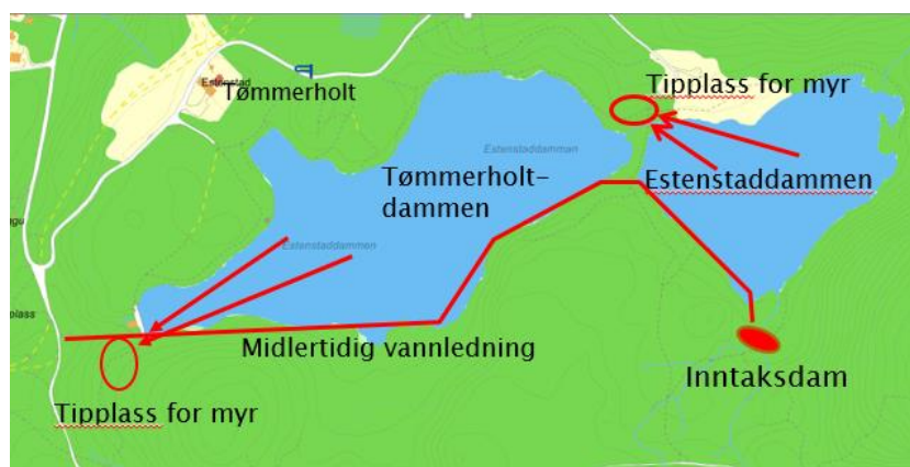
Figur 27. Plassering av reservedam og midlertidig vannledning fram til Tømmerholtdammen.
